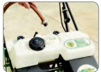
Wassertank als Zusatzgewicht von 25 kg bei AE 401 H.
