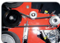
Langlebiger Messerwellenantrieb mit kugellagerter Metallspannrolle. Doppelriemen
