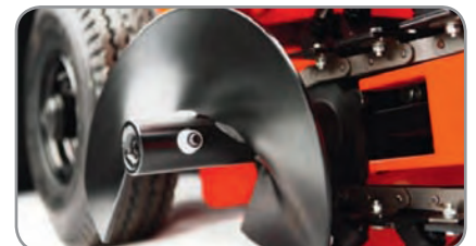
Förderschraube legt den Aushub sauber ab.
