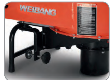
Robustes Einhängegerüst mit Kunststoffbuchsen.
