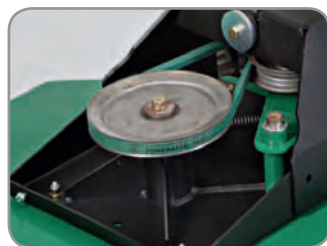
Überdimensionierter und wartungsfreier Messerantrieb
