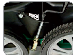
Stufenlose Höheneinstellung über Spindel.
