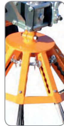
Einfaches nachstellen der Federstahlbürste
