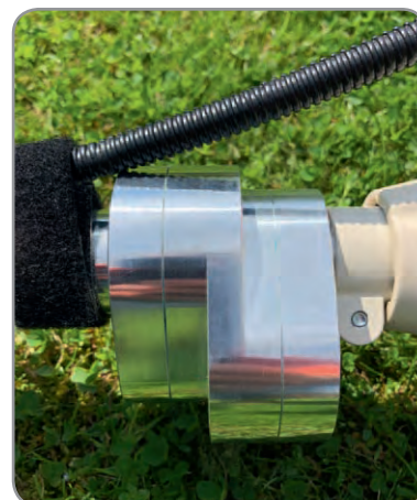
Reduktionsgetriebe (8.500 U/min. auf 450 U/min.)
