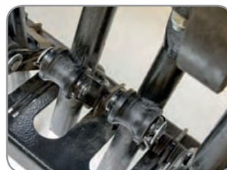
Laufbuchsenführungen für präzise Einstiche der Hohlzinken
