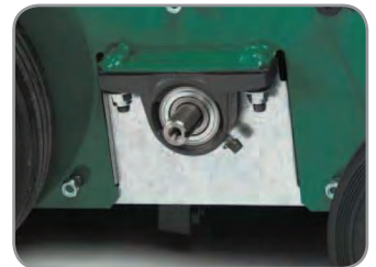
Abschmierbare, robuste Wellenlager.
