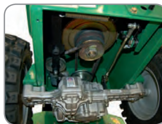
Tuff Torq® Hydrostat; eigentlich für den Antrieb von großen Aufsitzmähern geeignet. BC 2600 HHEU
