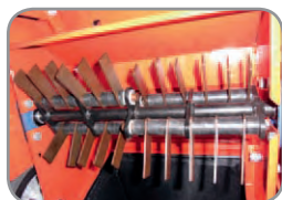
Am Fliehkraftsystem aufgehängte gehärtete 3 mm Vertikutiermesser.
