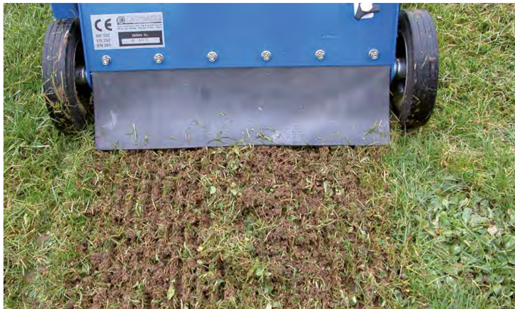
Schnittbild: pendelnde Messer bei einem Messerabstand von 1,9 cm.
