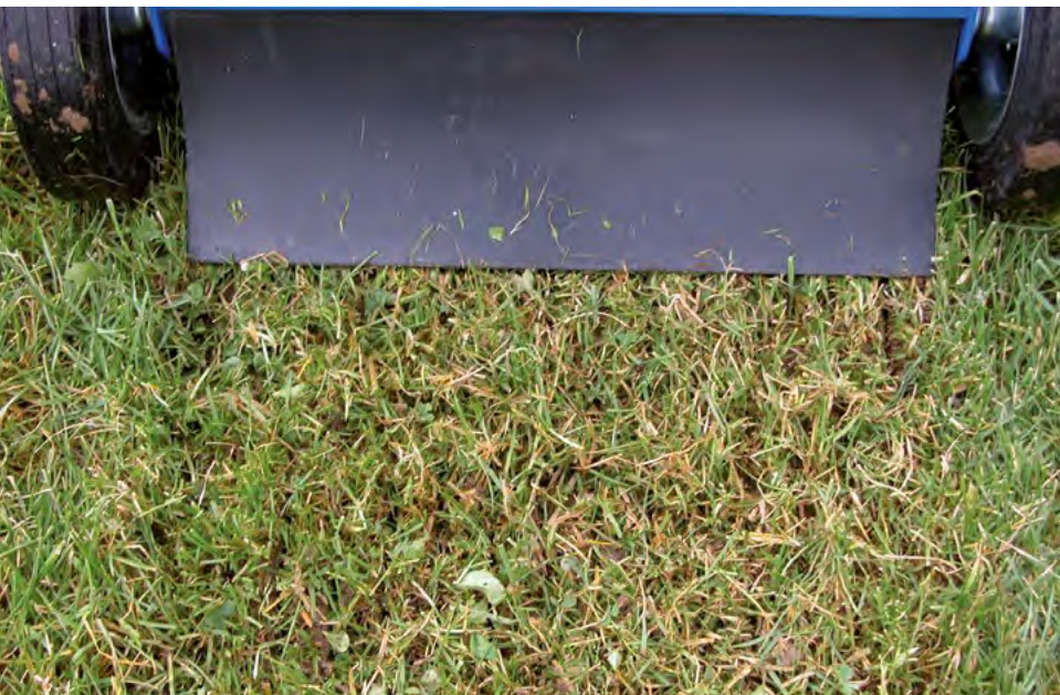
Schnittbild: feste Messer bei einem Messerabstand von 2,4 cm.
