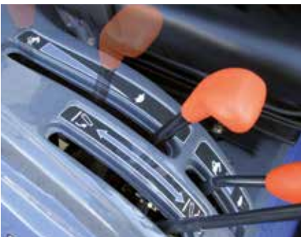
Einstellung der Fahrgruppen, der Mähwerksaushebung und des Tempomaten
