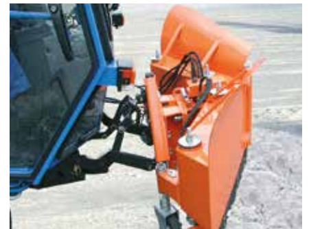
Mit einem Kombi-Keilschild können Sie Wege und Plätze effektiv von Schnee befreien.
