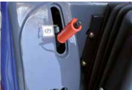
Der Handbremshebel ist in die Kulisse integriert. Für die Betätigung von bis zu 3 zusätzlichen Steuergerätefunktionen ist die Kulisse serienmäßig vorbereitet.
