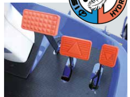
Durch zwei nebeneinander angeordnete Pedale wird der stufenlose, hydrostatische Fahrtrieb gesteuert.
