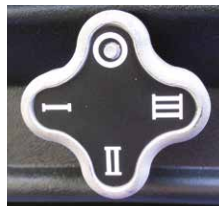
Einstellung der Sitzhöhe (bei Sitz mit mech. Federung)
