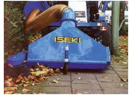
Spezial-Laubsaugeinrichtung mit integrierter Rotationsbürste
