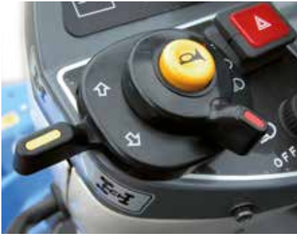
Kombi-Kontrollschalter der Beleuchtungsanlage
