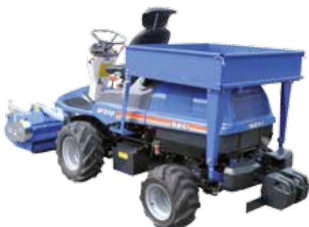
Die ISEKI-Transportpritsche nutzt den Platz über der Motorhaube optimal aus. Die stabile Befestigung erlaubt Tragkräfte bis 500 kg.
