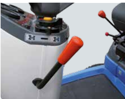
Zwei Allradmodi sind wählbar: Automatik oder Permanent
