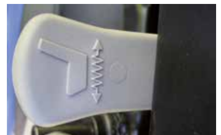
Einstellung der Horizontalfederung: das schont die Wirbelsäule zusätzlich.
