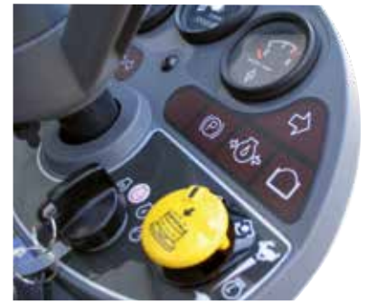
Lastschaltbare Zuschaltung der Zapfwelle. Inkl. Schnellstop-Funktion
